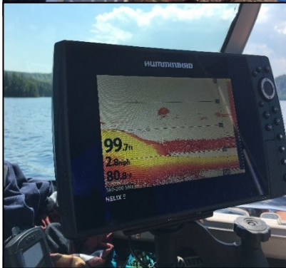
PHOTO 2 : Utilisation d'un Sonar nous permettant de visualiser la configuration du fond ainsi que les profondeurs des sites à l'étude ; cet appareil est nécessaire à la compréhension des types d'habitats car la visibilité et la profondeur sont des éléments limitant dans ces plans d'eau.
