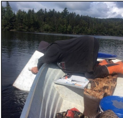
PHOTO 1 : Utilisation d'un aquascope (bathyscope) permettant de bien voir le substrat jusqu'à une profondeur d'environ deux mètres.
