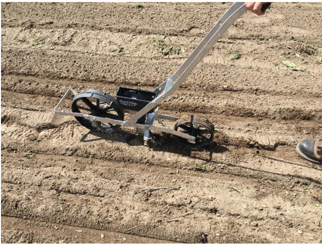
23-05 : Semis à la volée, au Earthway (disque "sweet corn) et au Jang (roulette LJ-12).
